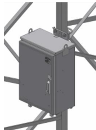
Rys. 60. Instalacja RC5_3 (obejma typu U)
